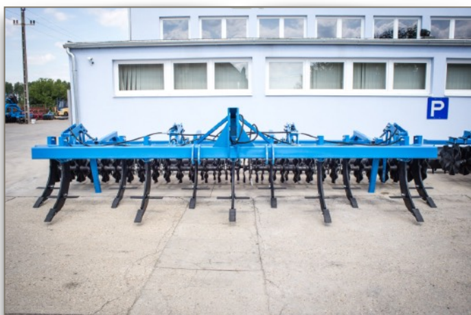
11 k. mélylazító, szárnyakkal (opció), hullámos tárcsával és rögtörővel (OPCIONÁLIS)
