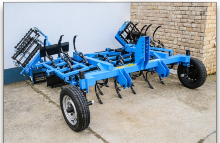
3,3m kézzel felhajtható kombinátor
