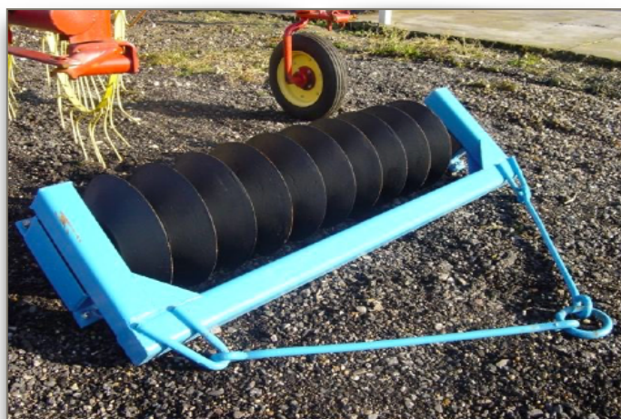
1,2m eke utáni gyűrűshenger (facsapágyas)
